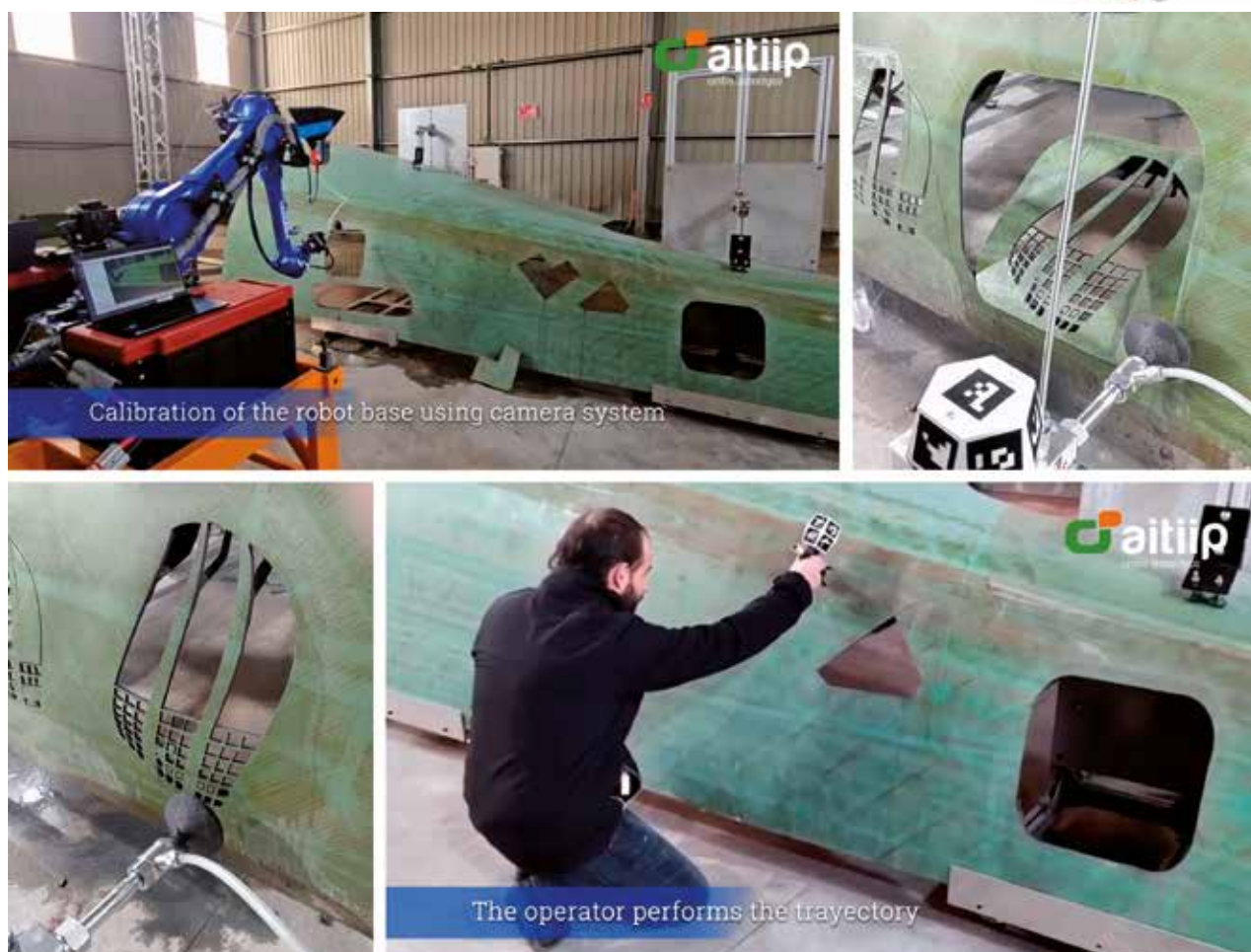
Demonstración de las técnicas robóticas de desmantelado. Cortesía de Aitiip
